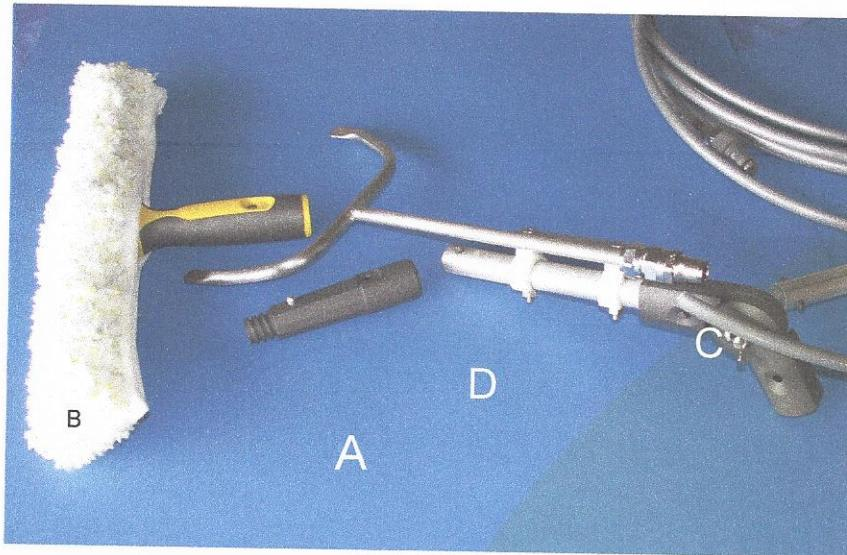
Adapteren A afmonteres fra teleskopskaftet og klikkes på vinkelletdet ved D
